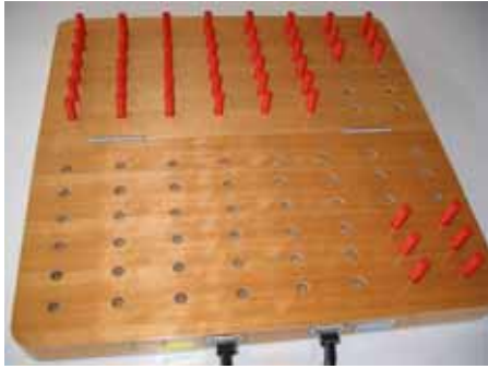
ペグ両手差し込み検査 (M検査)
